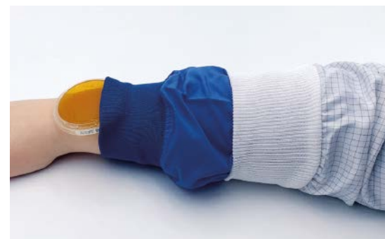
Abb. 1: Beispielhafte Darstellung einer Abklatschprobe auf der Reinraumbekleidung inkl. der einzelnen Bekleidungsschichten.
