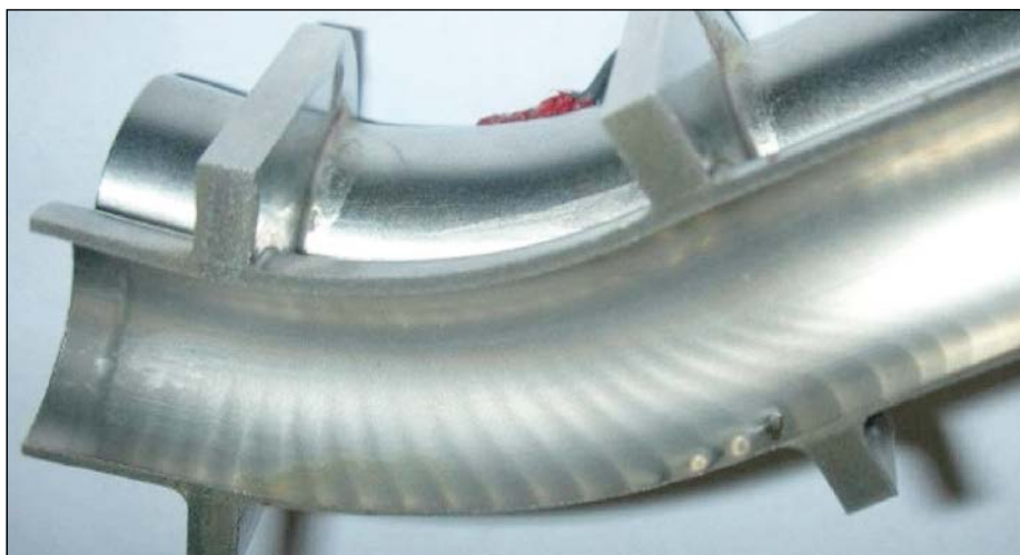
Abb. 1: Sichtbare Abnutzung im Coriolis-Messrohr durch Abrasion.
