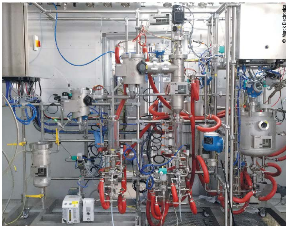
Beispiel eines standardisierten Anlagenmoduls (PEA) zur Rektifikation (Gegenstromdestillation) bei Merck in Darmstadt.
