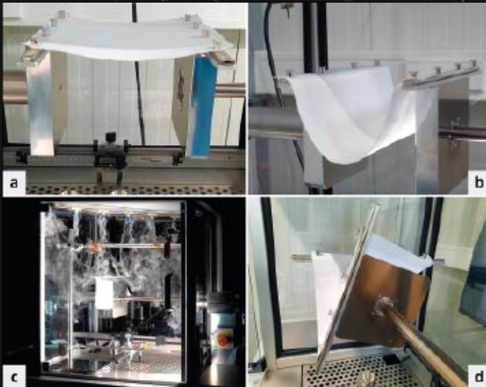
Abb. 3: a. Flach eingespanntes Reinraumtuch in Ausgangsposition; b. Faltbewegung; c. Strömungsvisualisierung und vollständig gefaltet; d. Drehbewegung
