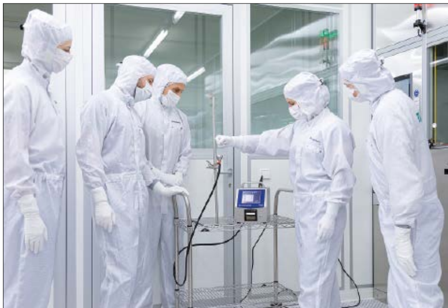
Abb. 2: Durchführung von Versuchen zum Personalverhalten im Reinraum
