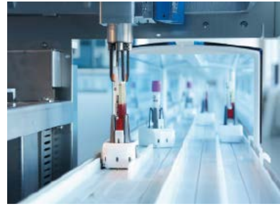
Abb. 2: Automatisches Probenverteilsystem mit hoher Flexibilität: Es befördert jede Probe (Specimen) einzeln, da nur so eine flexible, individuelle und optimierbare Organisation einzelner Proben möglich ist.
