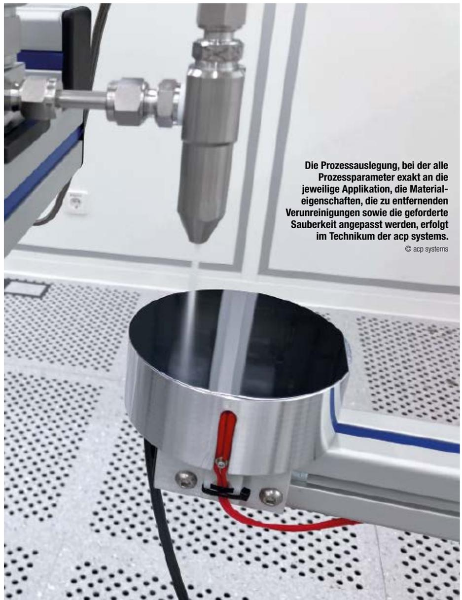
Die Prozessauslegung, bei der alle Prozessparameter exakt an die jeweilige Applikation, die Materialeigenschaften, die zu entfernenden Verunreinigungen sowie die geforderte Sauberkeit angepasst werden, erfolgt im Technikum der acp systems.
