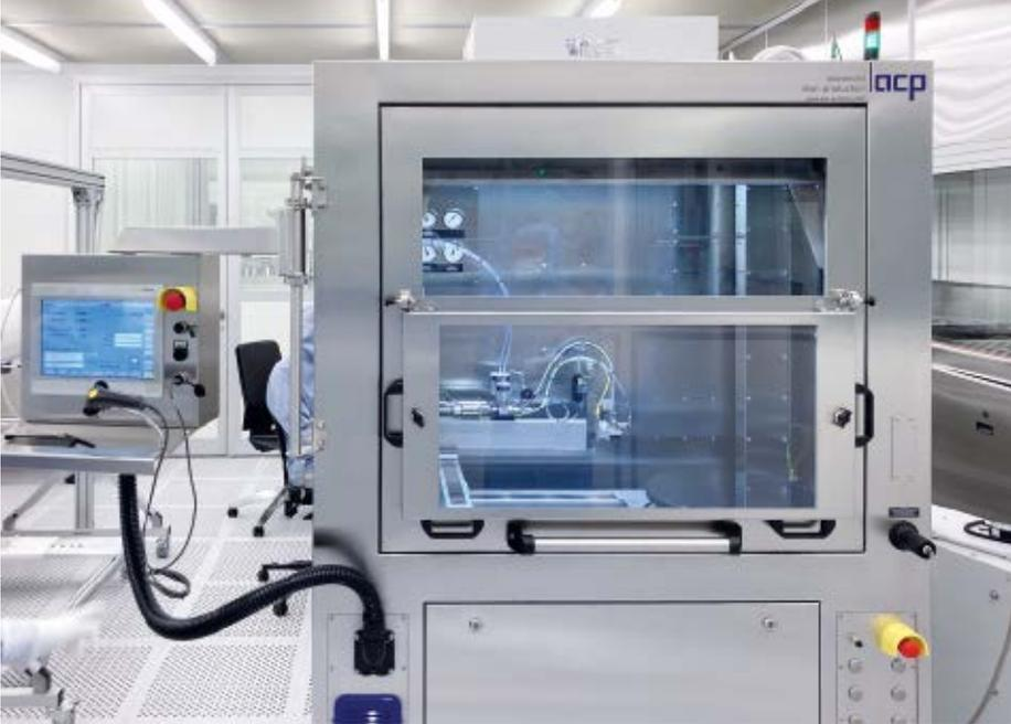
Die reinraumgerecht ausgelegte und ausgestattete JetStation-HP wurde für die flexible Reinigung bei höchsten Anforderungen an die Sauberkeit entwickelt. Sie wird manuell beladen und kann automatisiert oder teilautomatisiert als Standalone-Lösung betrieben werden.
