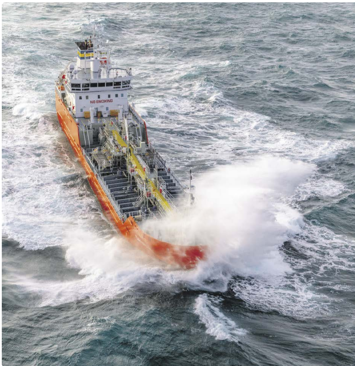
Einer der neuen Stainless-Steel-Tanker, M/T Scarlati, Baujahr 2022, mit 3.500 t Schwefelsäure in schwerer Nordsee.
