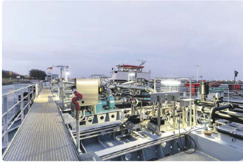
Das Niedrigwasserschiff „Courage“ verfügt über einen effizienten dieselelektrischen Antrieb, mit dem sich der Ausstoß von CO 2 im Vergleich zu anderen aktuell genutzten Schiffen um bis zu 30 % reduzieren lässt. Auch der Ausstoß von Feinstaub und sonstigen Schadstoffen wird signifikant reduziert. Zudem ist das Schiff H 2 - bzw. Future-Fuel-ready, d.h. es kann auf neuartige Antriebssysteme wie Wasserstoff umgerüstet werden, sobald diese marktreif sind.
