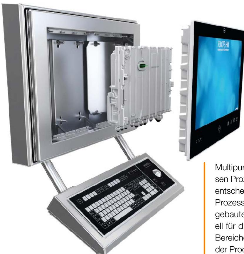
◀ Mit der Bediengeräteplattform ORCA wird das neue, kabellose EasyConnect-Stecksystem vorgestellt.
