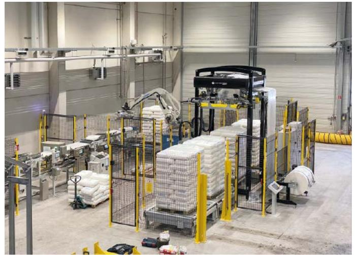
Palettier- und Roboteranlage im Logistikzentrum.
