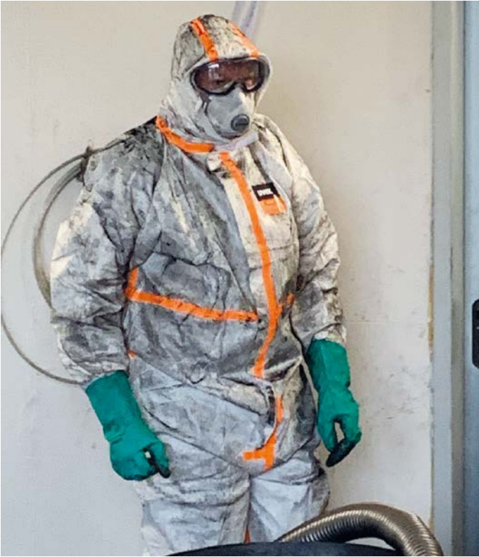
Bei herkömmlichen Absackverfahren von Carbon Black sind Mitarbeiter gefährlichen Stäuben ausgesetzt und müssen Vollschutz tragen.
