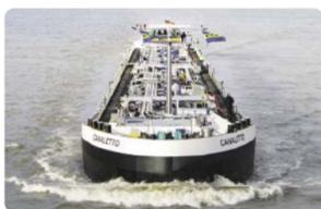
Für die maximale Flexibilität bei den zu transportierenden Chemieprodukten ist das Schiff mit acht Edelstahltanks ausgerüstet, davon zwei Spezialtanks mit besonderer Beschichtung in abgetrennten Tanksektionen. Drei getrennte Lade-/Löschsysteme bedeuten zusätzliche Flexibilität.
