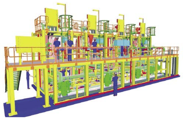
3D-Modell der Wasseraufbereitungsanlage mit Walnussschalenfiltration für NCOC in Kasachstan.
