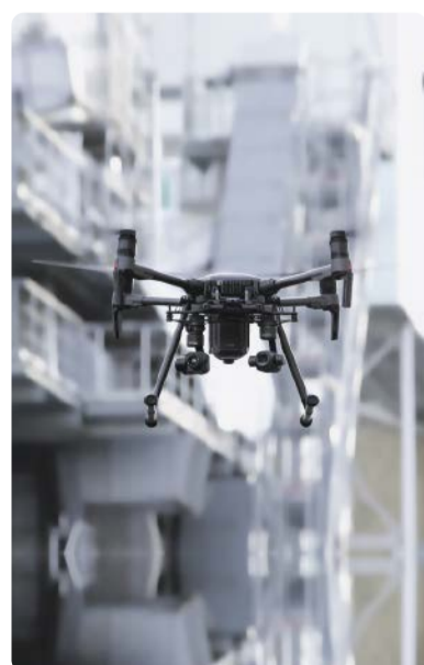
Industriedrohnen mit Wärmebildkamera können feststellen, ob und wo Wärme entweicht. © ISW
