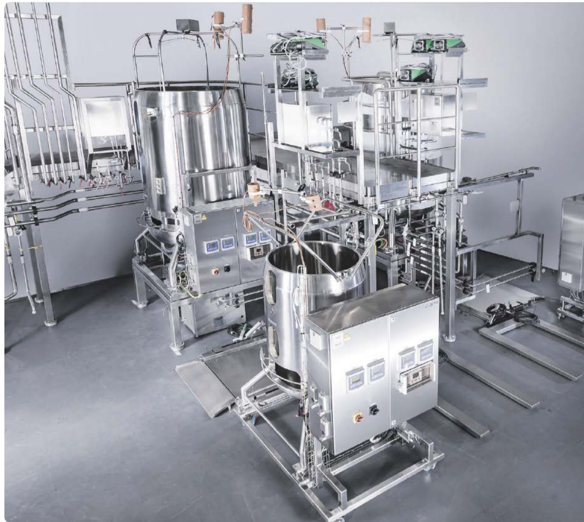
Edelstahlplattform für die Integration von vier Single-use Bioreaktoren (von 50 L bis 2.000 L).
