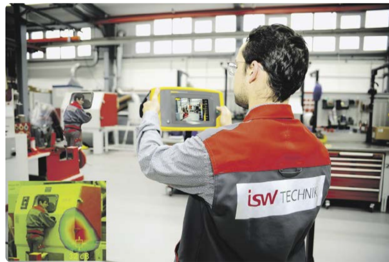
Schallkameras können Druckluftsysteme auf Leckagen überprüfen.
