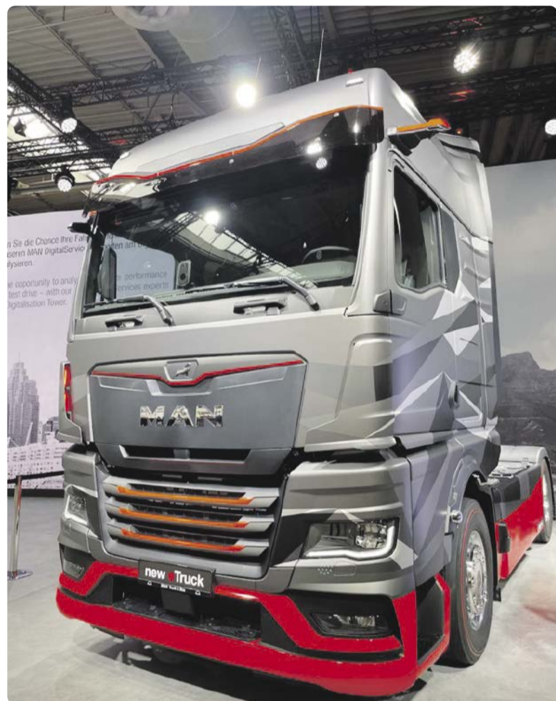
Laut Herstellerangabe mit 600 bis 800 km „Tagesreichweite“: Neue Sattelzugmaschine von MAN für den Lkw-Fernverkehr, kompatibel mit dem neuen MCS-Ladestandard. Das Fahrzeug wurde auf der IAA Transportation 2022 im September in Hannover ausgestellt.
