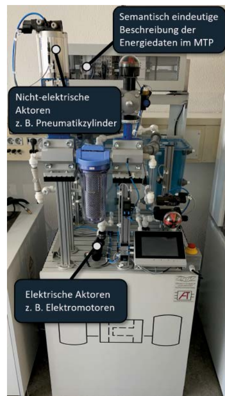
Beispielhafte Darstellung von Aktoren, die einen Einfluss auf den Energiebedarf eines Moduls haben.
