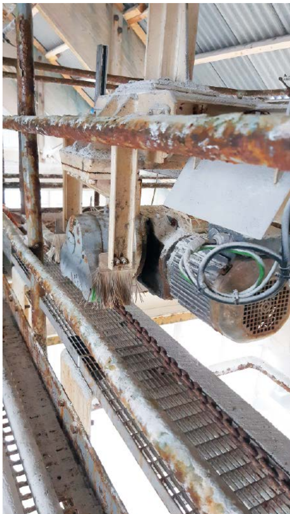
Das Antriebssystem bestehend aus Teccos Omega Drive Antrieb und der Rundstahlkette ist besonders robust gegen aggressive Medien und Witterungsbedingungen.
