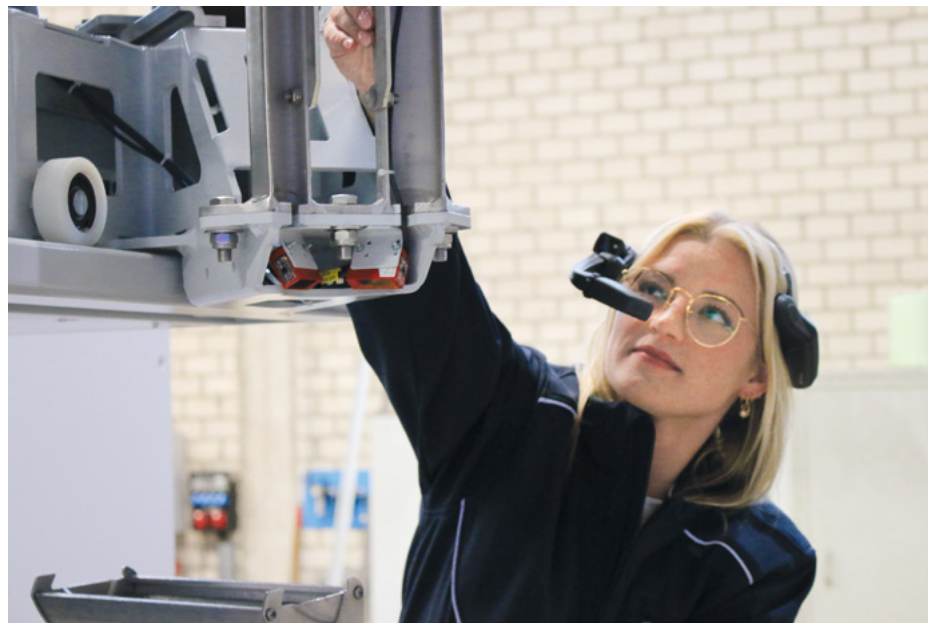
Die Digitalisierung nimmt weiter zu: Mit den Smart Glasses sieht der Beumer Customer Support das Gleiche wie der Träger vor Ort und kann den Kunden die richtigen Handgriffe direkt vorgeben.
