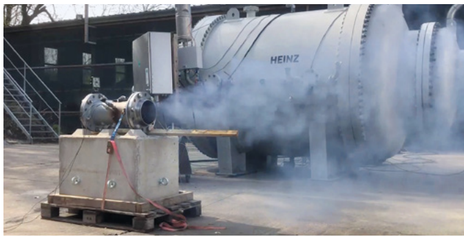
Links geschützt, rechts ungeschützte Entlastung eines propagierenden Batteriemoduls mit der Speicherkapazität eines Fahrrad Akkus (850 Wh).
