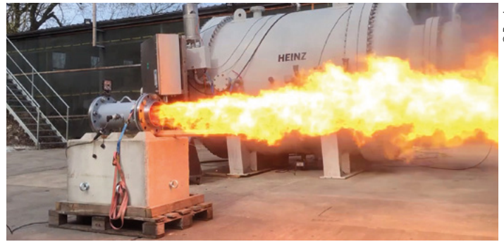
Links geschützt, rechts ungeschützte Entlastung eines propagierenden Batteriemoduls mit der Speicherkapazität eines Fahrrad Akkus (850 Wh).
