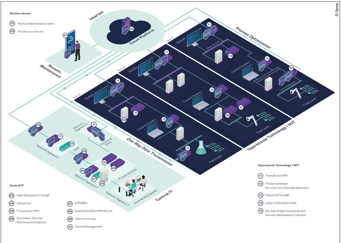
Abb.1: IT/OT-Referenzarchitektur für eine sichere digitalisierte Brownfield-Anlage. Implementierte Anwendungsszenarien sind hier u.a. die sichere Fernwartung, die Prozessoptimierung auf Basis von Edge Computing sowie die hochsichere Datenausleitung mittels Datendiode.
