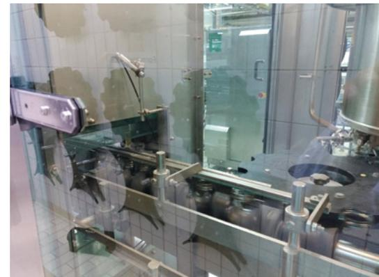
**Abb. 5:** Die akustischen Sensoren von ds automation lassen sich problemlos in bestehende Linien integrieren und erkennen Glasbruchvorfälle zuverlässig am Signalpegel und der Frequenzcharakteristik. © ds automation gmbh
