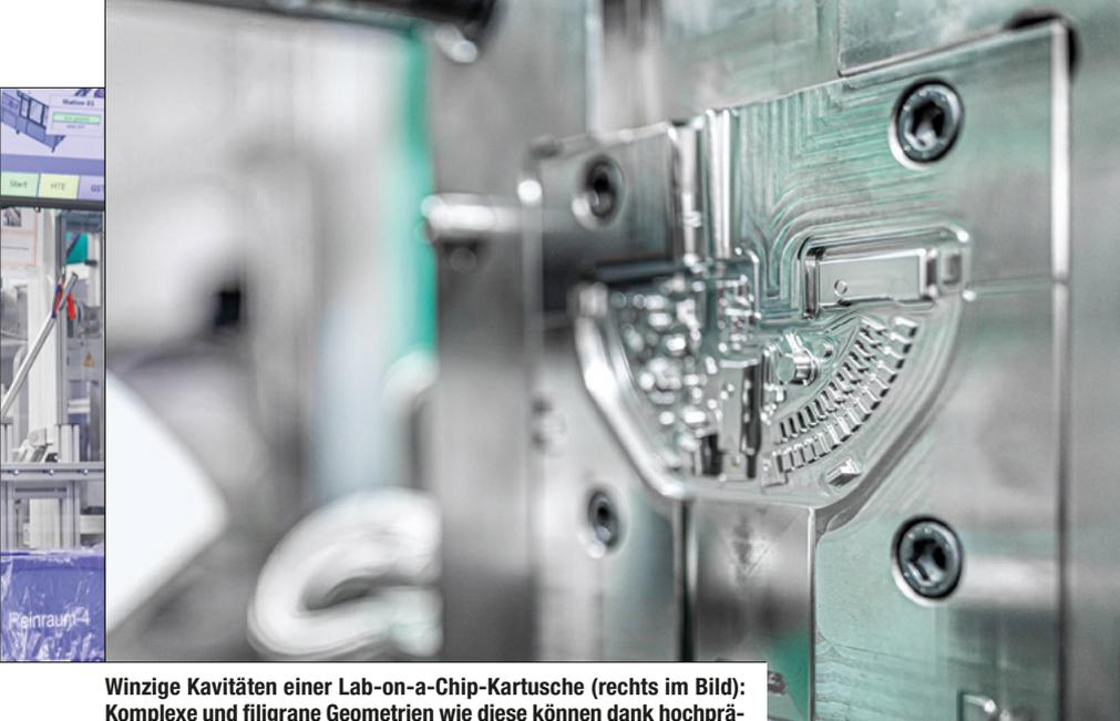
**Winzige Kavitäten einer Lab-on-a-Chip-Kartusche (rechts im Bild): Komplexe und filigrane Geometrien wie diese können dank hochpräziser Werkzeugtechnik und bestimmter Kunststoffe im Spritzgussverfahren effizient hergestellt werden.** © Rodinger Kunststoff-Technik GmbH
