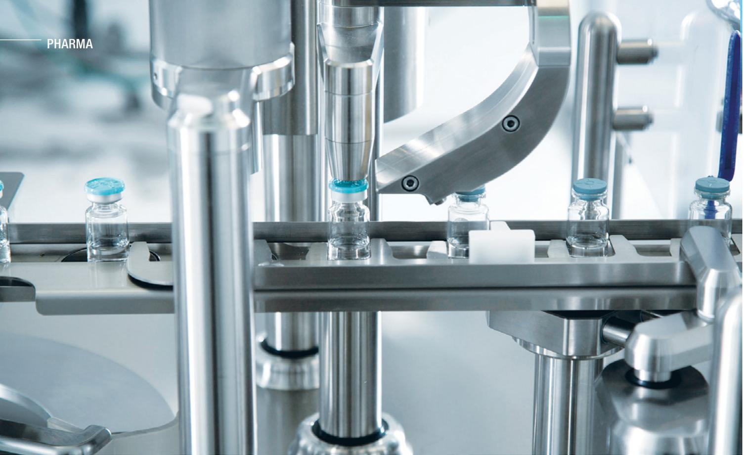
**Cellefill ist eine GMP-konforme Lösung für das Fill/Finishing von Vials** © Watson-Marlow Fluid Technology Solutions
