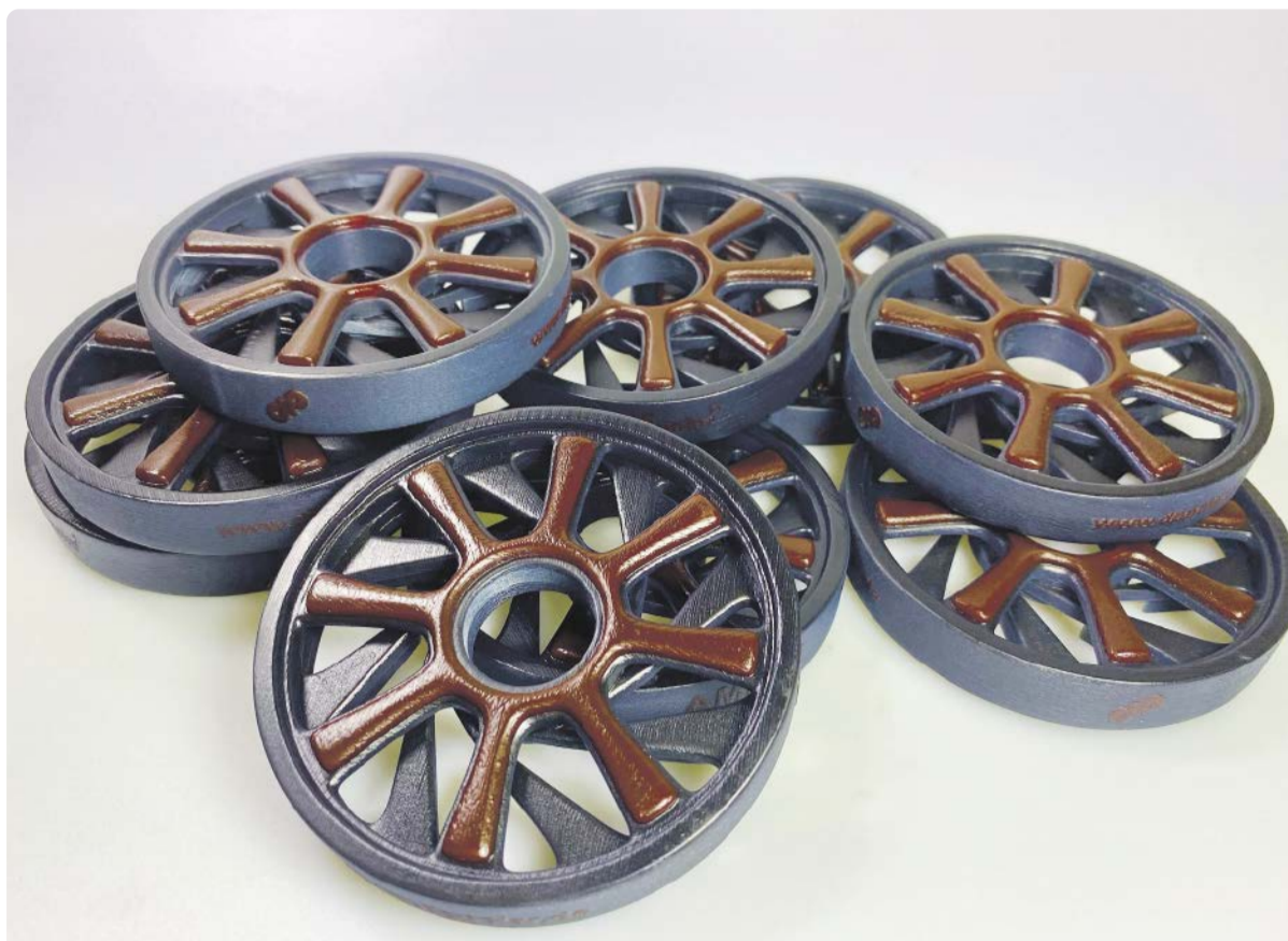
Multimaterial 3D-Druck mit Cubic Ink High-Performance-Materialien.
