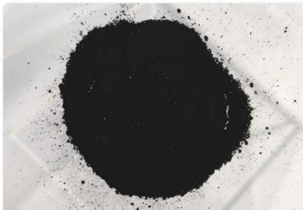
In dem von Alteva Technologies entwickelten Kathodenmaterial sind kritische Rohstoffe vollständig durch Schwefel und Kohlenstoff ersetzt. Die Ausgangsmaterialien sind günstig und weltweit nachhaltig verfügbar.
