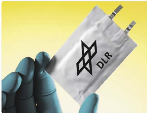
Funktionierender Prototyp einer Lithium-Schwefel-Batterie aus dem Labor. Mit Schwefel als Aktivmaterial weisen Batterien eine deutlich gesteigerte Energiedichte auf.
