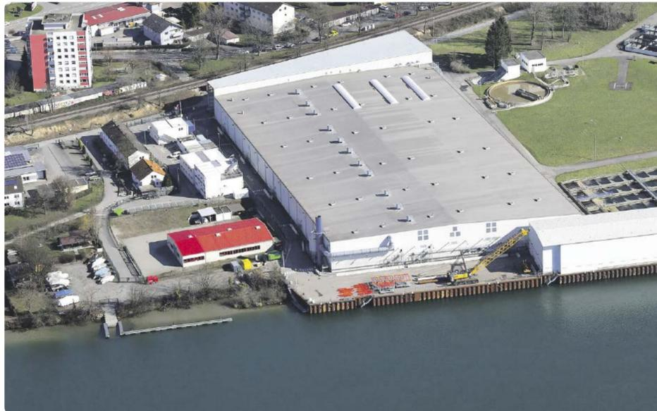
Luftaufnahme der Sanierungseinhausung sowie des temporären Schiffsanlegers für den Abtransport des belasteten Erdreichs in Spezialtransportcontainern.
