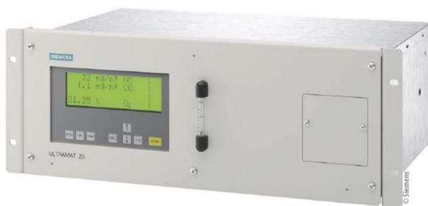
Durch seine Mehrkomponentenkonzeption mit UV- und NDIR-Technik zur Messung von bis zu drei IR- bzw. UV-aktiven Komponenten bietet der Gasanalysator Ultramat 23 ein hohes Maß an Wirtschaftlichkeit und Platzersparnis.
