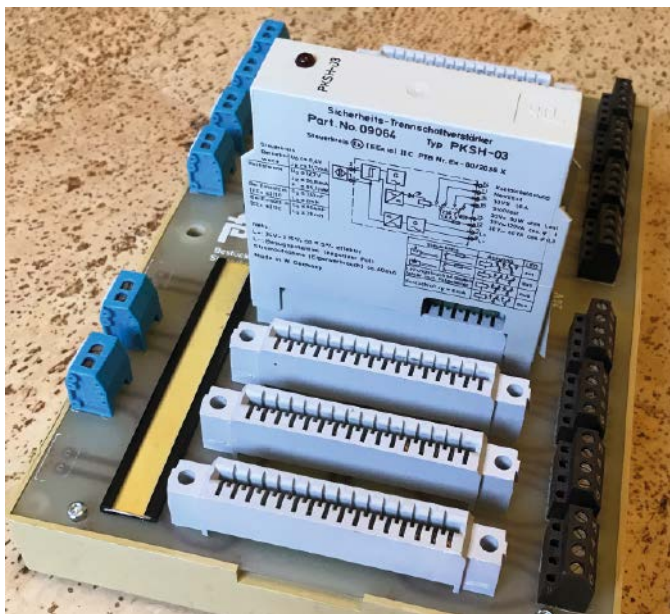
Sicherheitsschaltverstärker von 1980, montiert auf einem Termination Board.
