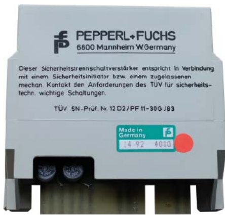
Pepperl+Fuchs entwickelte 1973 den ersten Sicherheitsschaltverstärker, hier ein Modell aus dem Jahr 1983.
