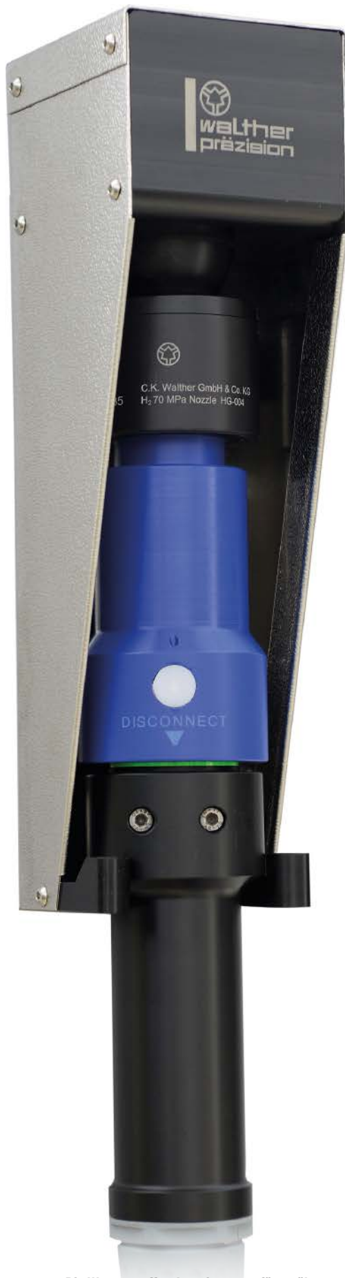
Die Wasserstoffparkstationen verfügen über ein integriertes Begasungssystem (gasförmigen Stickstoff oder trockene Luft). Ein Festfrieren der Betankungskupplung während der Betankung wird damit sicher verhindert.
