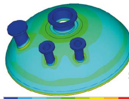
FEA-Analyse eines bestehenden Behälters.
