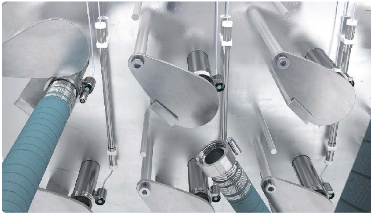
Stutzen mit RFID Lesekopf am Schlauchbahnhof
