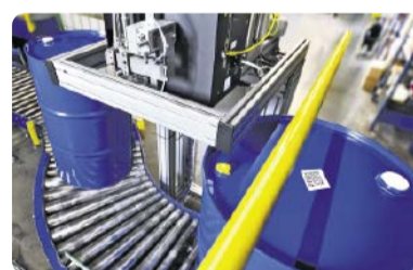
Schneller lokalisieren: Duttenhöfer gehört zu den ersten Unternehmen der Branche, die die Rückverfolgbarkeit von Chemie-Fässern gemäß der neuen VPA 9 ermöglichen; die Basis dafür bildet eine darauf abgestimmte Etikettier-Systemlösung von Herma.
