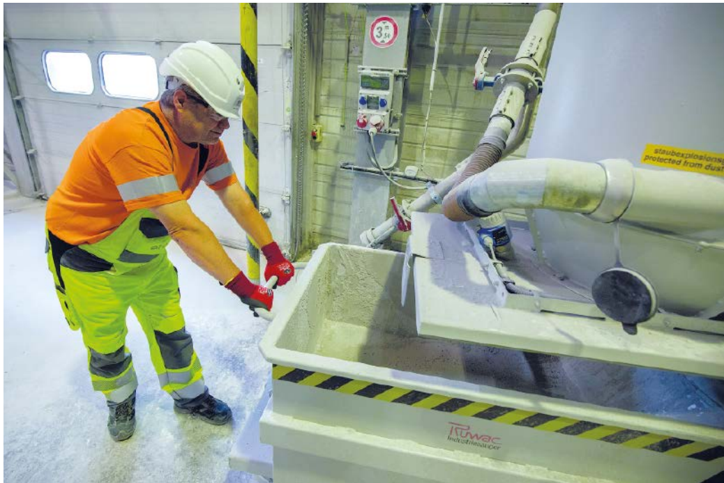
Der 500 kg fassende rollbare Sauggut-Container kann bewegt und per Stapler entleert werden, nachdem die Abscheideeinheit per Handkurbel angehoben wurde.
