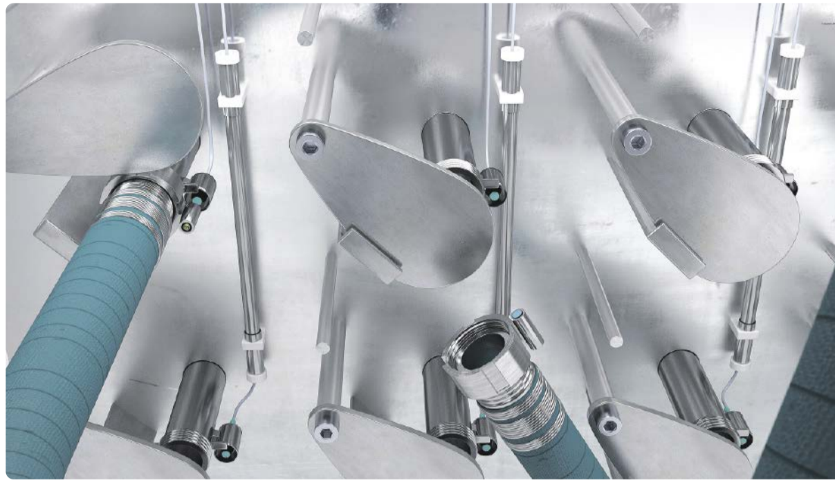
Stutzen mit RFID Lesekopf am Schlauchbahnhof
