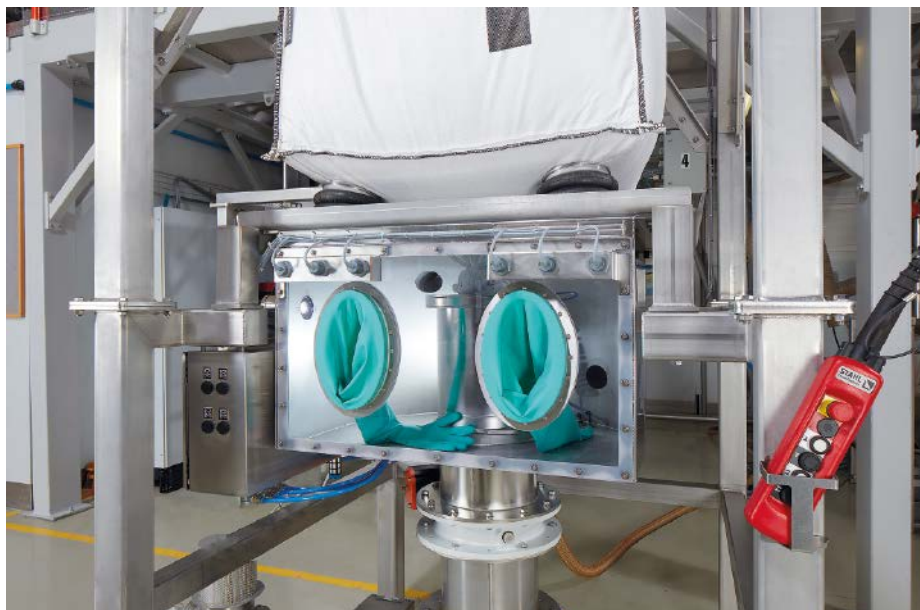
Die Glovebox sorgt für hohen, containmentgerechte, Produkt- und Bedienschutz.
