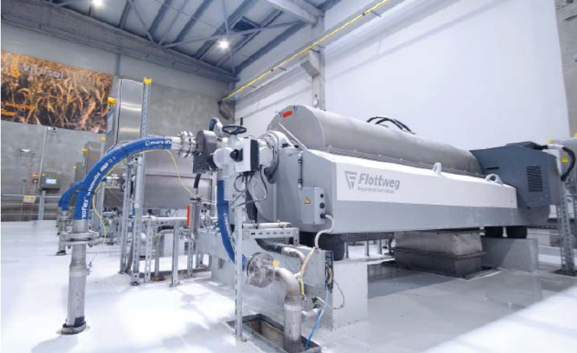
Flottwegs Zentrifugen übernehmen eine bedeutende Rolle bei der Herstellung von Weizenstärke.
