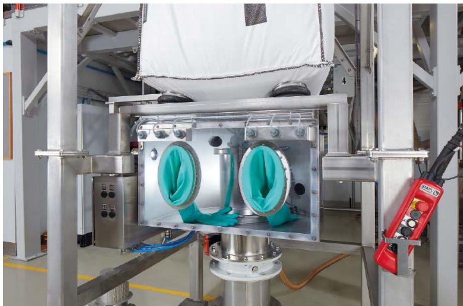
Die Glovebox sorgt für hohen, containmentgerechte, Produkt- und Bedienerenschutz.
