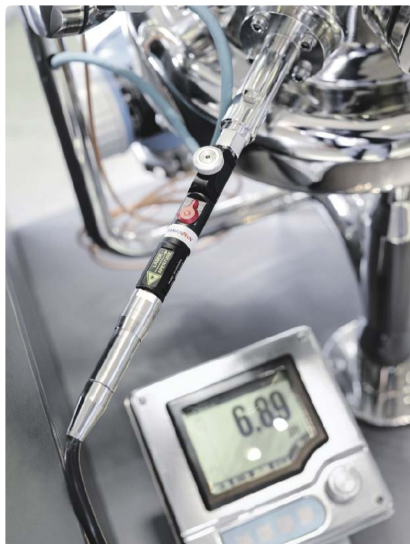
Raman-Sonde von Endress+Hauser in einem Gastankschiff. Analysesysteme auf Basis der Raman-Spektroskopie sind eine zuverlässige und wartungsarme Alternative zu herkömmlichen Gaschromatographieverdamper-Systemen für die Messung von Zusammensetzung und Energiegehalt von Flüssigerdgas bei eichpflichtigen Transaktionen. Zu diesem Ergebnis kommt eine Studie der European Gas Research Group (GERG), die verschiedene Verfahren vergleicht.
