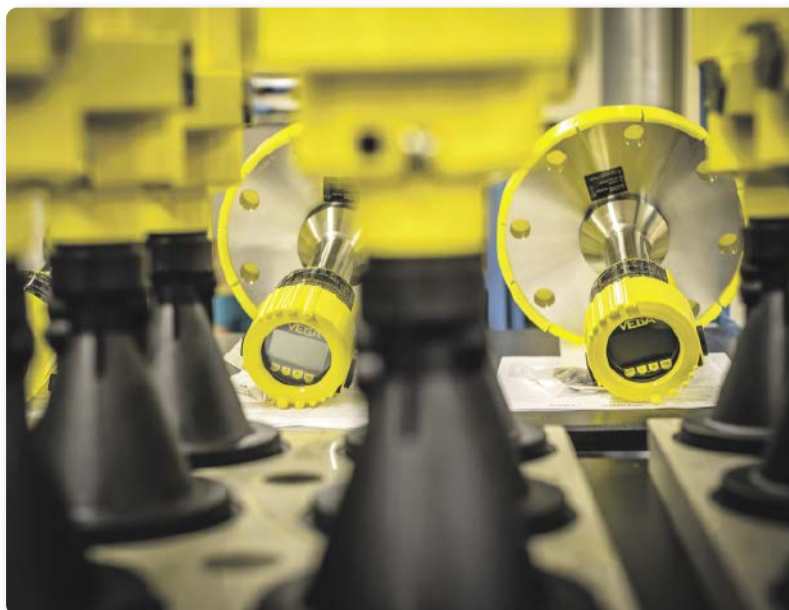
Der Radar-Füllstandsensoren Vegapuls 6X ist das Ergebnis aus 30 Jahren Erfahrung und über eine Million Sensoren im weltweiten Einsatz. Das Besondere: Es gibt nur noch einen Radarsensor, passend für alle Anwendungen und konfiguriert per Auswahlmeneü im Web.
