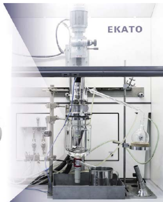
Laborkristaller mit dem Ekato-Viscoprop, das effiziente Suspendier-Rührorgan.
