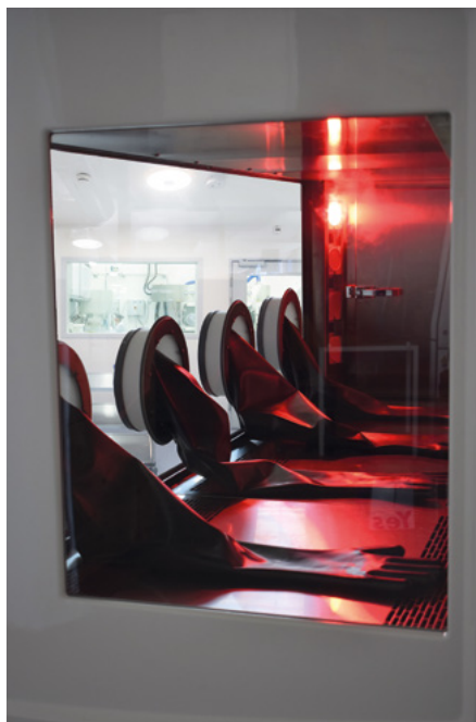
Abb. 2: Das Licht im Arbeitsbereich leuchtet im Alarmfall rot und ist so gut sichtbar.
