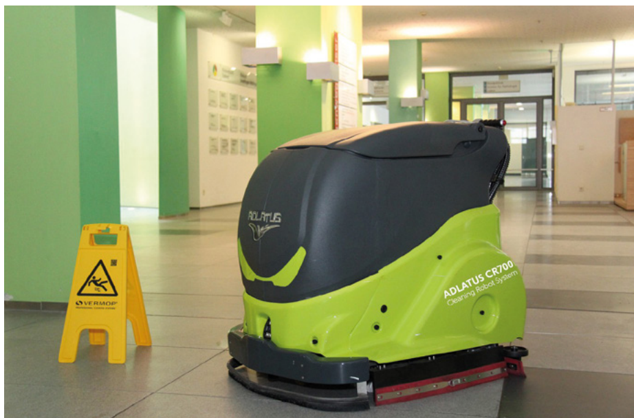
Existierende Bodenreinigungsroboter können bereits für die automatisierte Reinigung großflächiger Umgebungen eingesetzt werden.
