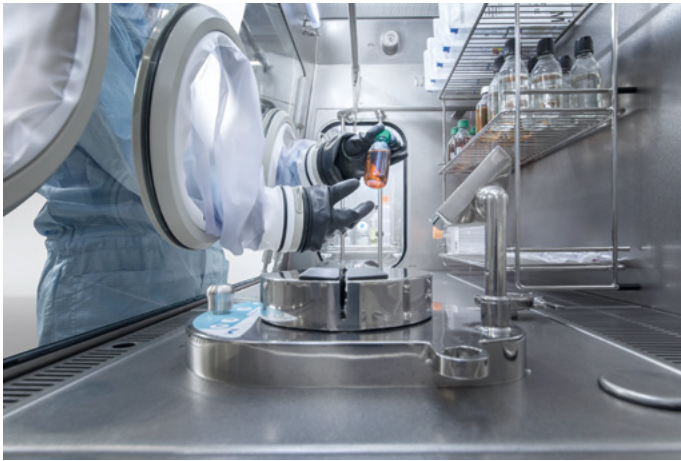
Abb. 1: Die pharmazeutischen Isolatoren schirmen die Bereiche zur Produktion und Abfüllung empfindlicher Güter, z.B. Impfstoffe, hermetisch ab
