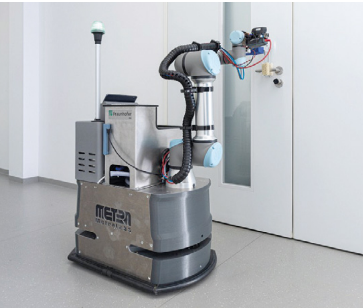
Abb. 1: Die Arbeiten des Fraunhofer IPA zur Reinigung und Desinfektion von Oberflächen basieren auf dem Roboter DeKonBot 2 und entwickeln dessen Fähigkeiten weiter.
