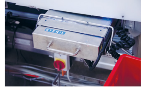
▲ Abb. 5: Berger Schinken nutzt ein UV-C-Banddesinfektionssystem von Sterilsystems an seinem Zerlegeband
