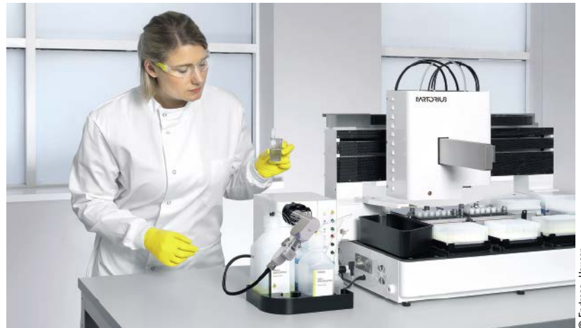
Die Rxn-46 Sonde an einem Sartorius BioPAT Spectrometer für einen Ambr 15 and Ambr 250 High Throughput-Reaktor.
