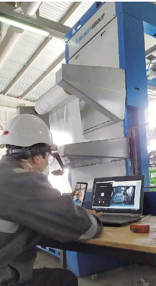
◀ Smart Glasses, Smartphone und Laptop schaffen für die Inbetriebnahme eine audio-visuelle Verbindung zum Anlagenbauer.
