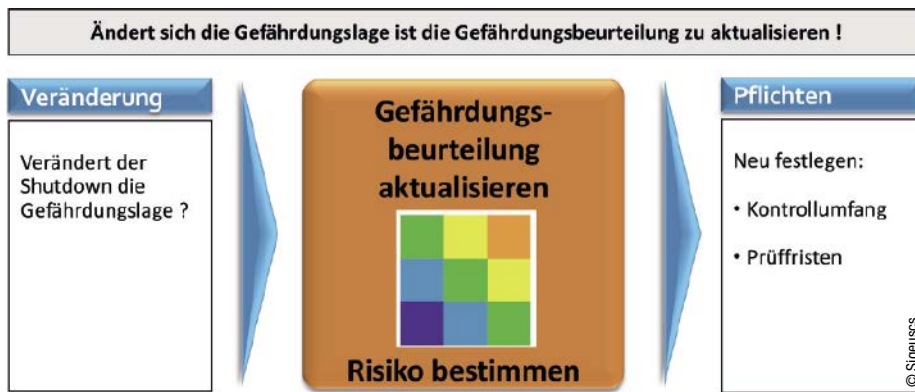
Gefährdungsbeurteilung zur Ermittlung der Prüf- und Kontrollpflichten.
