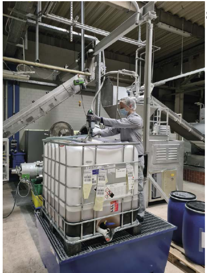
Der modulare Aufbau ermöglicht es, dass die fertige Pumpe dem jeweils zu fördernden Gut gerecht wird, z.B. mit längerem Förderrohr für IBC.
