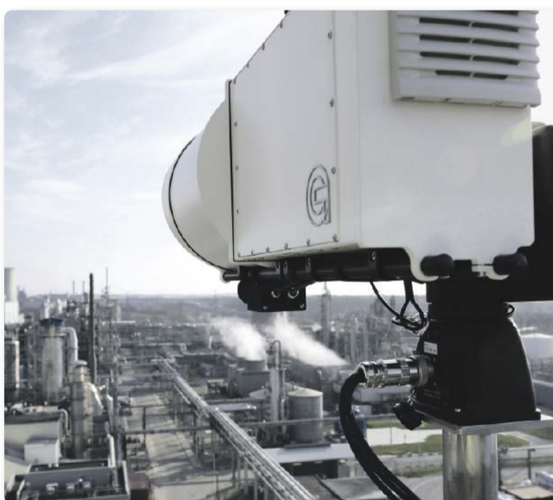
Wie ein Posten auf einem Wachturm identifizieren die Scanfeld-Sensoren Gasmoleküle in der Luft, analysieren die chemische Zusammensetzung und bestimmen Ort und Konzentration der Gaswolke.
