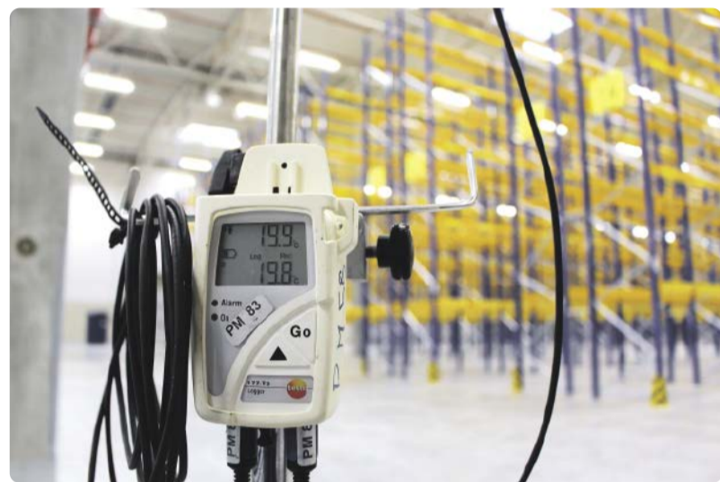
Vor Inbetriebnahme des Lagers führte EIPL ein umfangreiches Temperatur-Mapping durch.
