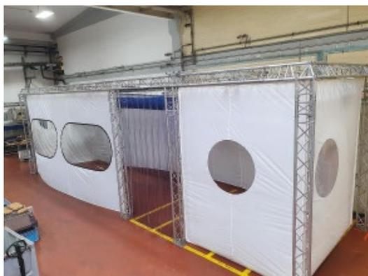
**Abb. 1: Reinraumkabine ISO 9 mit Lamellenvorhang in einer Produktionshalle**
