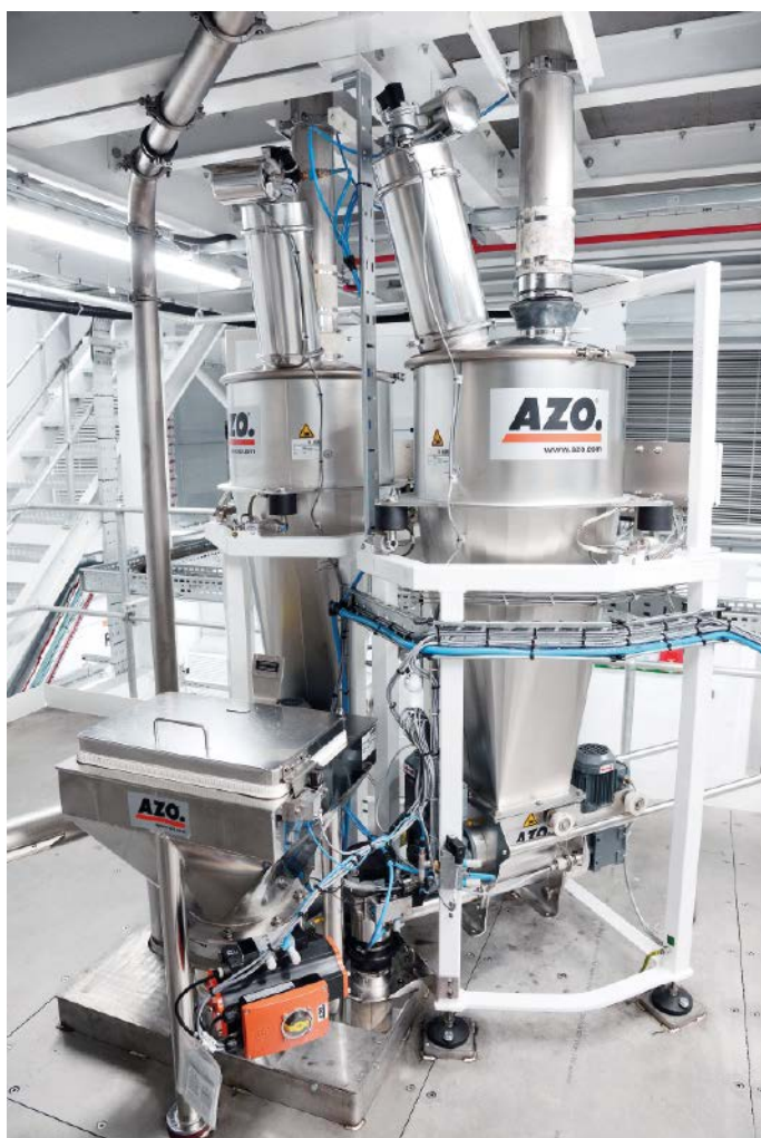
◀ Das Azodos-Dosiersystem für Binder und Leitadditive sowie Handaufgabestation für weitere Additive bei UKBIC.
