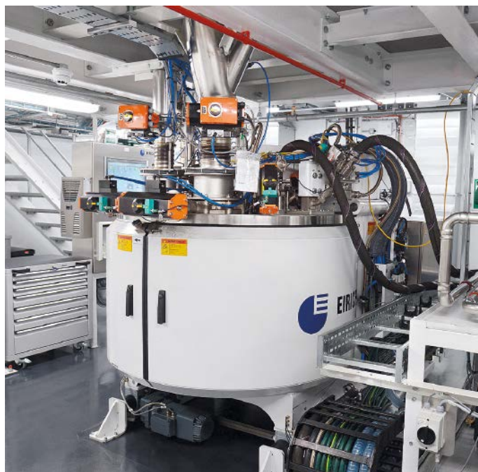
Der Mixsolver R12 ist das Herzstück der Eirich-Anlage zur Herstellung von Elektroden-Slurry bei UKBIC. ▼
