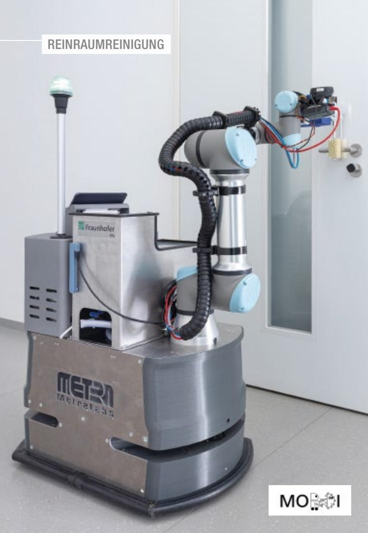
Mit seinen Reinigungsbürsten entfernt DeKonBot 2 groben Schmutz an der Türklinke und trägt gleichzeitig flächendeckend Desinfektionsmittel auf.
