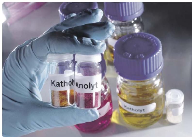
Polymere Aktivmaterialien für organische Redox-Flow-Batterien. Katholyt und Anolyt in fester (Vordergrund) und gelöster (Hintergrund) Form.
