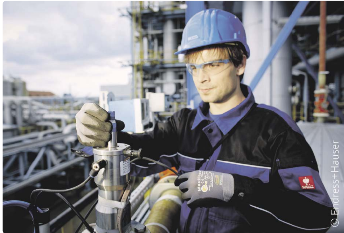
Einfacher und sicherer Sensortausch von vorkalibrierten digitalen Sensoren, hier am Beispiel eines Memosens pH Sensors von Endress+Hauser. Memosens Sensoren speichern alle sensorrelevanten Daten direkt im Sensorkopf und sind mit der vernetzten Erfassung von Mess-, Vital- und Prozessdaten optimiert auf vorausschauende Wartung im Rahmen von Industrie 4.0.
