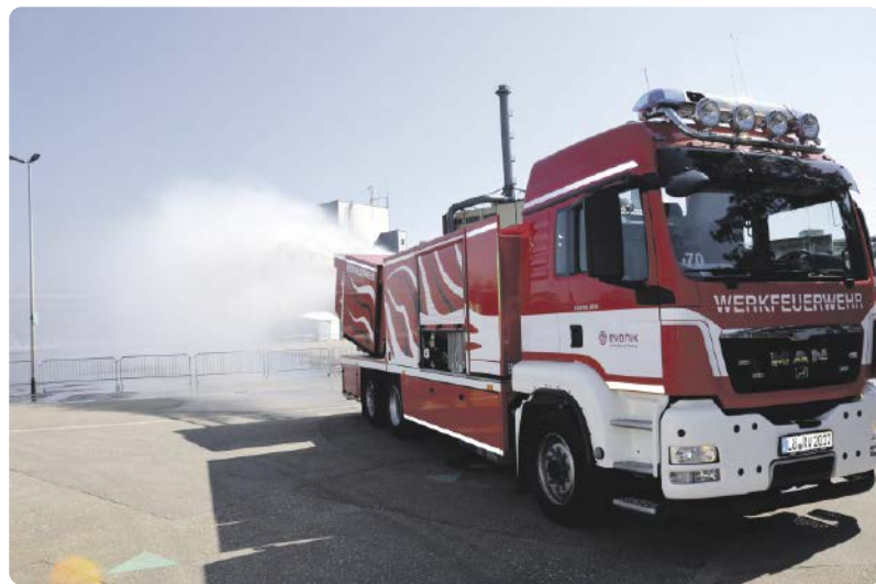
Mit der Power von zwei Flugzeugturbinen: Der Turbolöcher von Evonik ist das Löschfahrzeug mit der größten Reichweite der Werkfeuerwehr.
