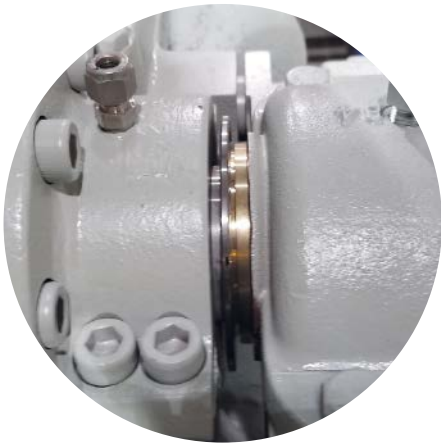
Die Inpro/Seal-Dichtungen lassen sich verschrauben, einpressen oder einkleben.
