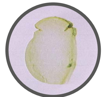
Abb. 2: Profilschnitt eines durch Quellung ausgefallenen O-Rings.
