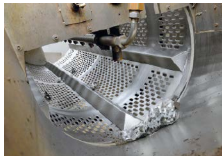
Für die Reinigung der Edelstahlringe hat Lobbe eine Waschmaschine mit Wasserhochdruck konstruiert.
