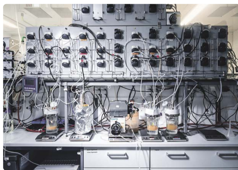
Das Hühnerdarm-Modell von Evonik: Bis zu fünf Glasgefäße, die durch Schläuche und Röhren miteinander verbunden sind, Reagenzien und Messgeräte.
