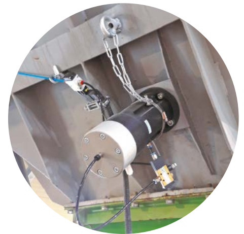
Einsatz des Klopfers an einem Silo eines Kohlekraftwerks.
