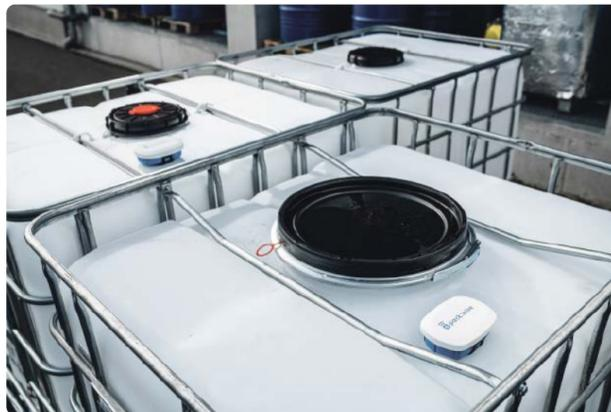
Die IBC werden im Plug&Play-Verfahren einzeln mit Packwise Smart Caps ausgestattet. Anschließend erfolgt die „Verheiratung“ (Matching) der entsprechenden Smart Caps mit dem bestückten Container anhand einer mobilen Applikation.
