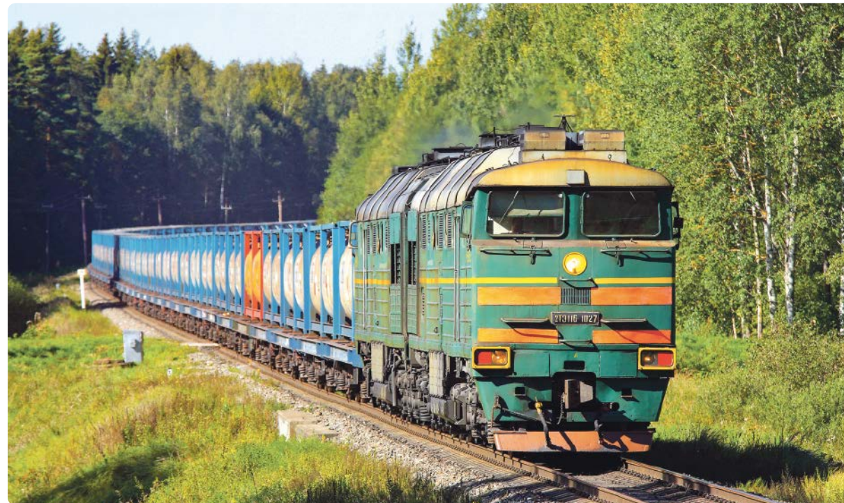
Tankcontainer in Richtung Osten vor Ludza, Lettland. Die russische Grenze liegt 40 km weiter. Sowohl hier als auch in Russland haben die Schienen einen Abstand von 1.520 mm; in China und den meisten EU-Ländern beträgt der Standard 1.435 mm.
