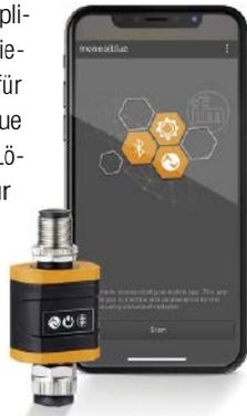
IO-Link-Sensoren über Bluetooth zur Verfügung. Damit lassen sich die aktuellen Prozessdaten einzelner Sensoren direkt an der Maschine schnell überprüfen. Durch die recht gute Reichweite von Bluetooth ist diese Funktion besonders
