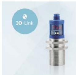
Abstandswert in mm/cm direkt am Sensor an. Der Push-Pull-Schaltausgang kann im Standard-IO-Modus auch als Schaltausgang (sowohl pnp als auch npn) genutzt werden. Die crm+ Sensoren in einer M30-Edelstahlhülse erfassen kontinuierlich Füllstände von Flüssigkeiten oder Schüttgütern aller Art, die Schall reflektieren. So ist eine berührungslose Füllstandsmessung unabhängig von Farbe oder Transparenz möglich. Gegenüber Staub und
