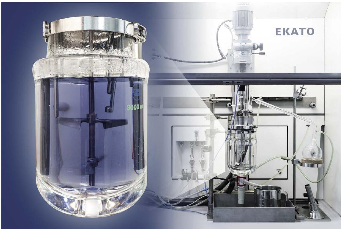
Abb. 2: 3-I-Kristallisationsapparatur im Labor
