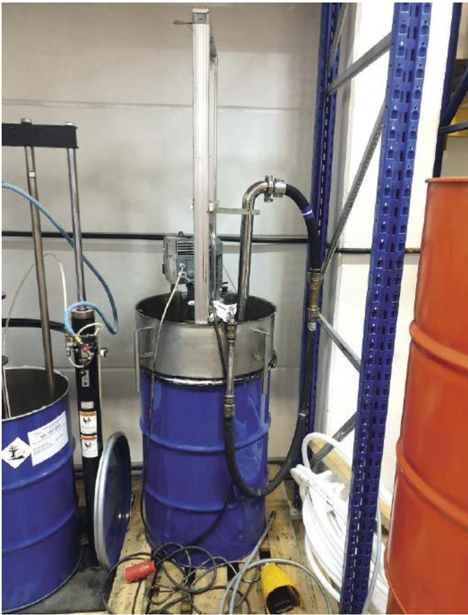
Abb. 2: Für offene 200 l Fässer mit nicht mehr fließfähigen Medien gibt es das mobile Fassentleerungssystem Viscoflux. Dieses fördert per Exzenterpumpe zähflüssige bis pastöse Medien.
